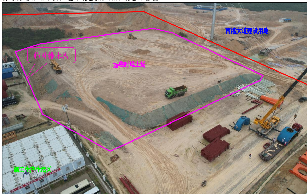
2#临时堆土场用地现状图，堆土边界处的临时排水沟本季度运行较好，排水最终以埋暗管的形式向东排入厂外现状排水沟渠。因堆土场土方随进随出变化较快，土体表面施工未能全区采取临时苫盖
