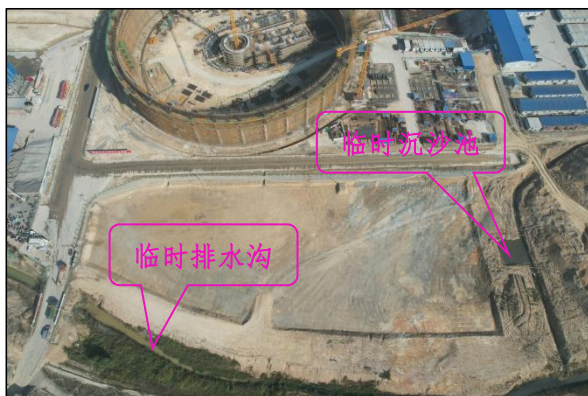
厂区建设区南面现状图，临时排水沟、临时沉沙池现状排水沉沙效果良好，现状无较大水土流失
