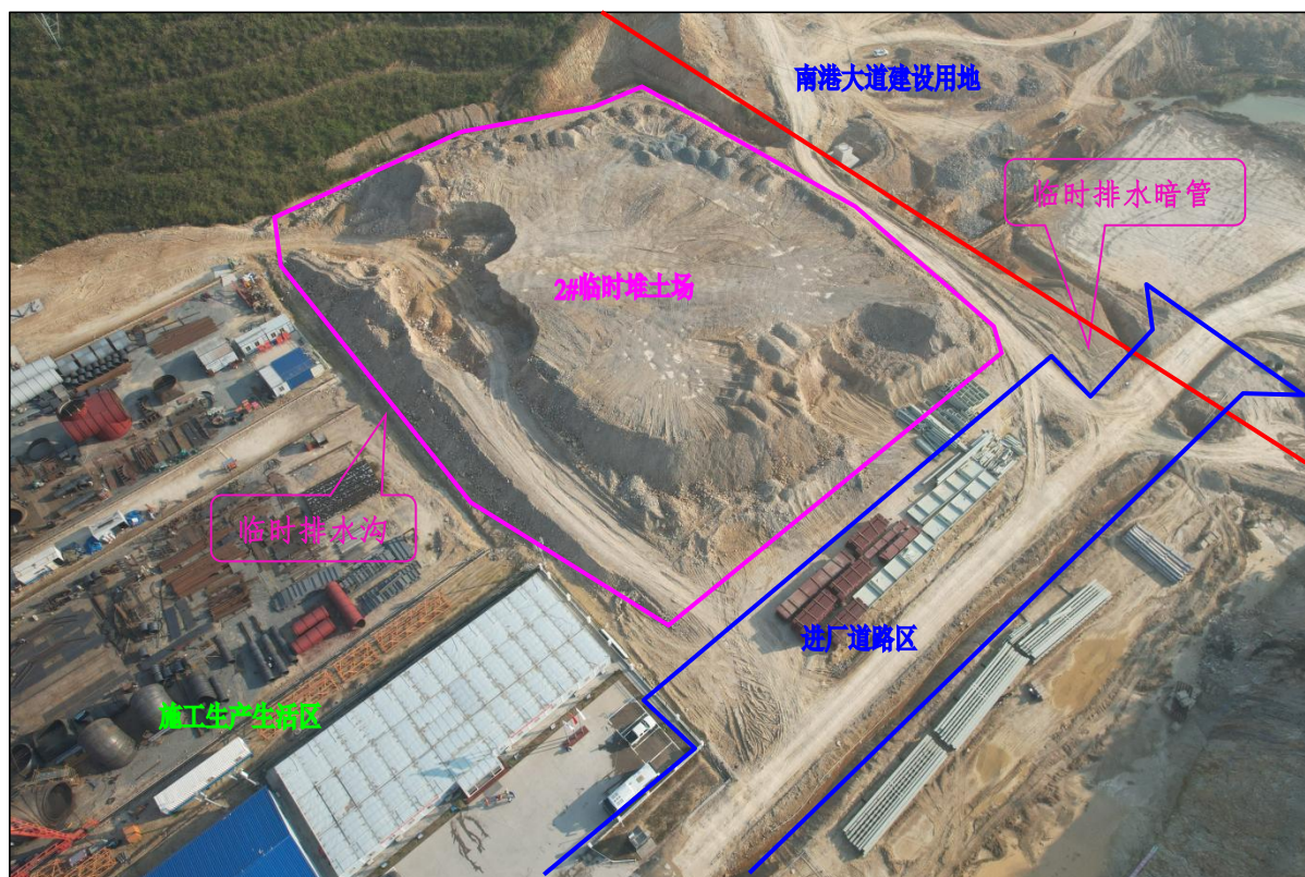
2#临时堆土场用地现状图，堆土边界处的临时排水沟本季度运行较好，排水最终以埋暗管的形式向东排入厂外现状排水沟渠。因堆土场土方随进随出变化较快，土体表面施工未采取临时苫盖
