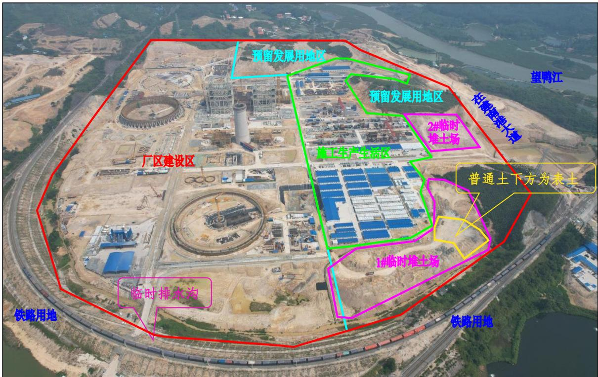
本季度末期建设现状图，厂区建设区主体正在进行构筑物基础建设，施工生产生活区已完成建设。本季度主体施工扰动均在永久征地范围内，进厂道路区临时用地因南港大道施工已全区扰动，施工虽造成一定水土流失，但未造成水土流失危害
