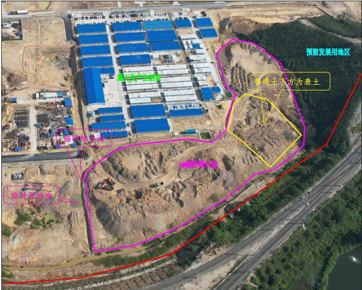
1#临时堆土场用地现状图，施工将其布设在预留发展用地区用地内南面，表土堆土场已并入 1#临时堆土场用地中。场地排水采用施工前期布设的临时排水沟和施工生产生活区布设临时排水沟的形式，本季度新增设置临时沉沙池，但土体表面无临时苫盖，堆土四周无彩钢板拦挡，遇降雨水土流失量较大
