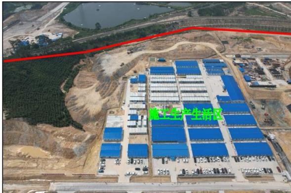
施工生产生活区南面现状图，施工已完成地面硬化、板房搭建，用地无较大水土流失
