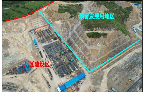
厂区建设区用地西面、北面现状，主体正在进行构筑物基础建设，施工扰动均在永久征地范围内
