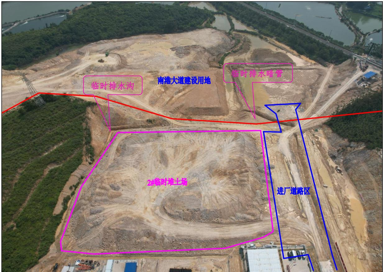
2#临时堆土场用地现状图，该区为本季度新增设置，布设在进厂道路区（货运出入口）北侧，施工在2#临时堆土场西北面、北面布设了临时排水沟，排水最终以埋暗管的形式向东排入厂外现状排水沟渠。
