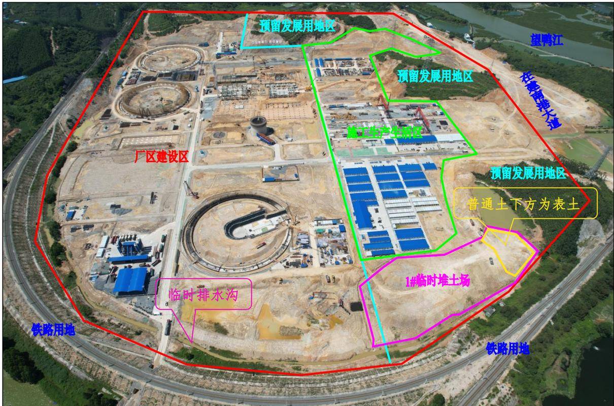
本季度初期建设现状图，厂区建设区主体正在进行构筑物基础建设，用地中坑塘水面区域为待建区，非基坑开挖造成的积水。施工生产生活区正在进行基础建设，本季度主体施工扰动均在永久征地范围内，进厂道路区临时用地因南港大道施工已全区扰动，施工虽造成一定水土流失，但未造成水土流失危害
