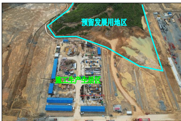
施工生产生活区布置现状图，本季度施工生产生活区正在进行基础建设，同时在地中部及边界处合理布设临时排水沟，但未布设临时沉沙池
