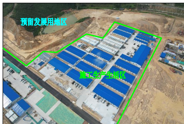
施工生产生活区布置现状图，本季度施工生产生活区正在进行基础建设，同时在地中部及边界处合理布设临时排水沟，但未布设临时沉沙池
