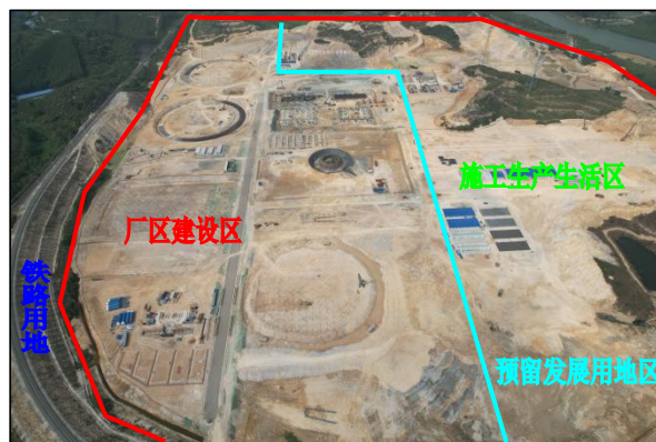
厂区建设区、预留发展用地区南面施工现状图，厂区建设区处于构筑物基础建设阶段，预留发展用地区用于施工生产生活区建设
