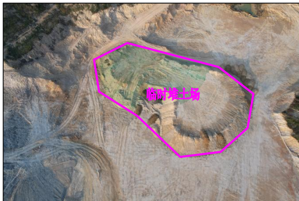
临时堆土场用地现状图，本季度临时堆土场布设位置有所调整，施工将其布设在预留发展用地区用地内北面，堆土坡面已临时苫盖密目网，但堆土边界处未布设临时排水沉沙、临时拦挡措施
