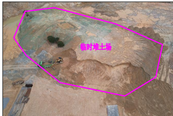
临时堆土场用地现状图，本季度临时堆土场布设位置有所调整，施工将其布设在预留发展用地区用地内北面，堆土坡面已临时苫盖密目网，但堆土边界处未布设临时排水沉沙、临时拦挡措施
