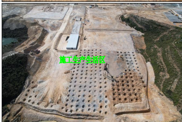
施工生产生活区布置现状图，本季度施工生产生活区开始建设，均布设在预留发展用地区内，施工正在进行基础建设，同时在地中部及边界处合理布设临时排水沟，但未布设临时沉沙池
